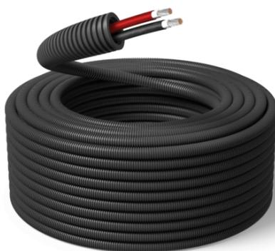
Vorverdrahtetes Anti-UV-Rohr mit H1Z2Z2-K Anti-UV-Solarkabel. Das Wellrohr ist beständig gegen UV-Strahlen und Witterungseinflüsse und daher für Außeninstallationen und Photovoltaikanlagen mit direkter Sonneneinstrahlung geeignet, und Halogen Free (halogenfrei) in Übereinstimmung mit EN50642.
