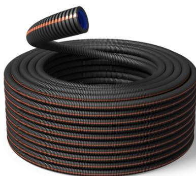
La gaine Pmflex HiSpeed est transversalement élastique et totalement sans micro-trous, adaptée pour un emploi en béton et ciment. La gaine a un glissement très élevé: la paroi intérieure est composée de polymères réduisant la friction de 55% par rapport à une gaine standard en polypropylène. Elle est aussi écologique, LSF0H (Low Smoke Flame retardant Zero Halogen). La ligne colorée le long de la paroi extérieure indique la mesure du diamètre: orange 16 mm, bleu 20 mm et jaune 25 mm.
