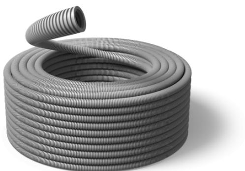
La gaine Pmflex ICTA est transversalement élastique et totalement sans micro-trous, adaptée pour un emploi en béton et ciment. Elle a un système spécial de lubrification intérieure pour les diamètres 16, 20 et 25 mm, et souplesse et glissement élevés. La gaine est écologique, LSF0H (Low Smoke Flame retardant Zero Halogen), et sa couleur est gris (RAL 7037).
