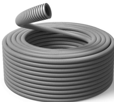
La gaine Pmflex ICTA est transversalement élastique et totalement sans micro-trous, adaptée pour un emploi en béton et ciment. Elle a un système spécial de lubrification intérieure pour les diamètres 16, 20 et 25 mm, et souplesse et glissement élevés. La gaine est écologique, LSF0H (Low Smoke Flame retardant Zero Halogen), et sa couleur est gris (RAL 7037).
