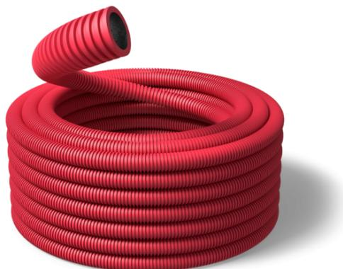
Conduit TPC en polyéthylène, composé par deux éléments tubulaires : un élément extérieur annelé et un élément intérieur lisse. Il est idéal pour la protection des câbles dans les installations électriques et téléphoniques souterraines et il a une résistance chimique aux substances acides et basiques, aux hydrocarbures, aux détergents, aux substances inflammables et à l'eau. Utilisation avec les accessoires compatibles MN et PCC, et conformité à la norme EN 61386.1 – EN 61386.23.
