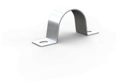
Cavalier de fixation pour la protection des câbles avec des trous ovales pour faciliter l'installation. Tous les produits de la gamme sont traités en surface avec Magnelis, un revêtement métallique à l'avant-garde extrêmement efficace dans la protection contre la corrosion, même dans les environnements les plus hostiles. Une capacité unique d'auto réparation des trous forés, des raccords soudés et des surfaces de coupe, et enfin, une plus faible empreinte environnementale.
