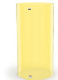
Manchons avec ressorts pour la jonction de gaines cintrables. Emploi en béton et ciment. Colorés et transparents : couleurs différentes pour chaque diamètre et transparence pour contrôler aisément la jonction de gaines. Écologiques : Low Smoke Flame retardant Zero Halogen.
