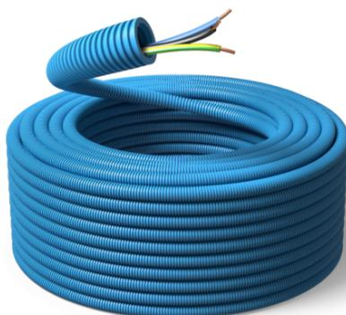
Il tubo flessibile corrugato resistente a 1000 N preinfilato con fili energia H07Z1-U LSZH consente un significativo risparmio di tempo: i tempi di installazione si dimezzano, perché l'operazione di infilaggio dei fili non deve essere eseguita.
