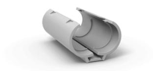
Raccordi ispezionabili IP50 “apri&chiudi” per la giunzione di tubi pieghevoli, utili anche per proteggere tubi danneggiati. Sono ecologici (Low Smoke Flame retardant Zero Halogen) e di colore grigio (RAL 7035).
