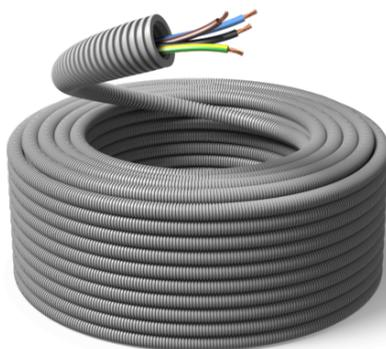
Il tubo flessibile corrugato ICTA pre-infilato con cavi energia FG17 LSZH consente un significativo risparmio di tempo: i tempi di installazione si dimezzano, perché l'operazione di infilaggio dei cavi non deve essere eseguita.
