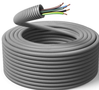
Il tubo flessibile corrugato ICTA pre-infilato con cavi energia H07Z1-K LSZH consente un significativo risparmio di tempo: i tempi di installazione si dimezzano, perché l'operazione di infilaggio dei cavi non deve essere eseguita.
