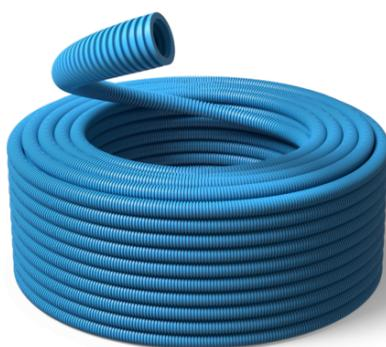
Il tubo Pmflex corrugato in PVC è ideale in installazioni di tipo standard che non richiedono l'uso di materiali LSF0H; non è adatto all'uso con calcestruzzo liquido e cemento armato. Il tubo è realizzato in PVC ecologico ed è anche lubrificato internamente per facilitare l'infilaggio e lo sfilaggio dei cavi. Il colore del tubo è blu (RAL 5015).
