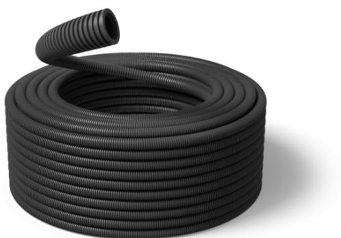
Il tubo Pmflex corrugato in PVC è ideale in installazioni di tipo standard che non richiedono l'uso di materiali LSF0H; non è adatto all'uso con calcestruzzo liquido e cemento armato. Il tubo è realizzato in PVC ecologico ed è anche lubrificato internamente per facilitare l'infilaggio e lo sfilaggio dei cavi. Il colore del tubo è nero (RAL 9004).
