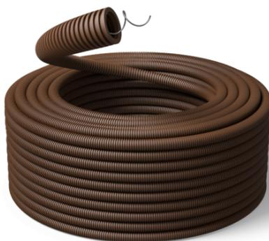
Il tubo Pmflex corrugato in PVC con filo è ideale in installazioni di tipo standard che non richiedono l'uso di materiali LSF0H; non è adatto all'uso con calcestruzzo liquido e cemento armato. Il tubo è realizzato in PVC ecologico ed è anche lubrificato internamente per facilitare l'infilaggio e lo sfilaggio dei cavi. Il colore del tubo è marrone (RAL 8012).
