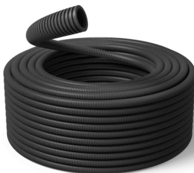
Tubo corrugato in PVC, ideale in installazioni di tipo standard che non richiedono l'uso di materiali LSZH; non è adatto all'uso con cemento liquido e calcestruzzo. Il tubo è realizzato in PVC ecologico ed è lubrificato internamente per facilitare l'infilaggio e lo sfilaggio dei cavi. Colore: nero RAL 9004.
