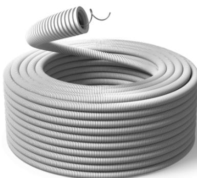
Tubo corrugato in PVC, ideale in installazioni di tipo standard che non richiedono l'uso di materiali LSZH; non è adatto all'uso con cemento liquido e calcestruzzo. Il tubo è realizzato in PVC ecologico ed è lubrificato internamente per facilitare l'infilaggio e lo sfilaggio dei cavi. Colore: bianco perla RAL 1013. Tubo con tirafilo.
