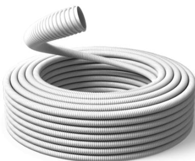
Guaina flessibile spiralata 2311, priva di piombo e conforme alla direttiva RoHS, è dotata di un sistema a tenuta stagna che garantisce un grado di protezione IP65 se utilizzata con raccordi RAI, RAG o RAP, e IP66 con raccordi RK. Colore: grigio RAL 7035.
