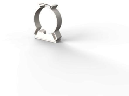
Clip a collare per il fissaggio di tubi rigidi. Di colore grigio (RAL 7035) e realizzate in materiale termoplastico ecologico: Halogen Free (senza alogeni) secondo la normativa EN 50642.
