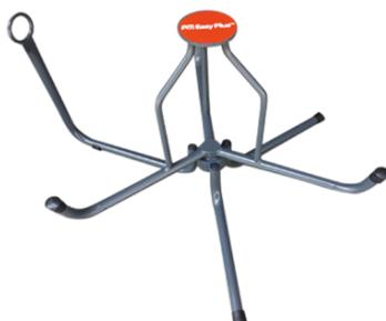
GoEasy Plus è la versione rinforzata dello srotolatore universale in acciaio zincato, adatto ad un utilizzo più intensivo. Consente di svolgere ogni tipo di tubo avvolto in rotoli di normale dimensione in modo semplice, veloce e ordinato. Inoltre, consente di mantenere integro l'imballo del rotolo.
