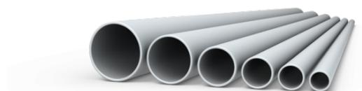
Tubi rigidi HF di classe media realizzati in poliolefina autoestinguente ed ecologici: Halogen Free (senza alogeni) secondo la normativa EN 50642. Il loro utilizzo è ideale per gli impianti a vista eco-compatibili (pareti interne e soffitti) e sono anche curvabili a caldo nei diametri 16, 20 e 25 mm con l'ausilio delle molle piegatubo MOPI.
